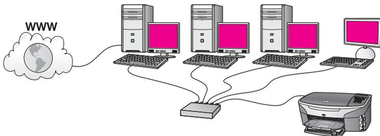
В този пример мрежовите устройства са свързани чрез комутатор или рутер. Шлюз между мрежата и интернет е компютър. Компютърът, който функционира като шлюз, използва компонента за споделяне на интернет връзката (ICS) или подобен софтуер, за да управлява мрежови връзки и предостави достъп до интернет на останалите устройства.
