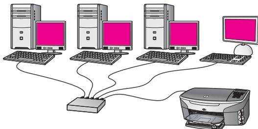
В този пример мрежовите устройства са свързани с комутатор или рутер и няма връзка към интернет. Устройствата използват AutoIP, което означава, че IP адресите им се конфигурират автоматично. Ако използвате тази конфигурация, свържете HP all-in-one към комутатора или рутера с помощта на Ethernet кабел. За инструкции за връзка, вж. [Връзка с Ethernet кабел](#).
