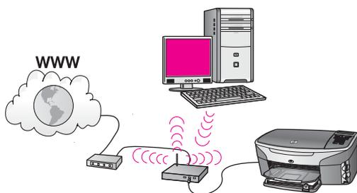
Устройството за точка на достъп свързва кабелно устройство с безжична мрежа. В тази конфигурация компютърът е конфигуриран за безжична мрежа с помощта на безжичен адаптер, като данните се обменят чрез устройството за точка на достъп. HP all-in-one е конфигуриран за кабелна мрежа и е свързан с устройството за точка на достъп чрез Ethernet кабел. С помощта на DSL или кабелен модем може да се предостави връзка към интернет. За инструкции за връзка, вж. [Връзка с Ethernet кабел](#).
