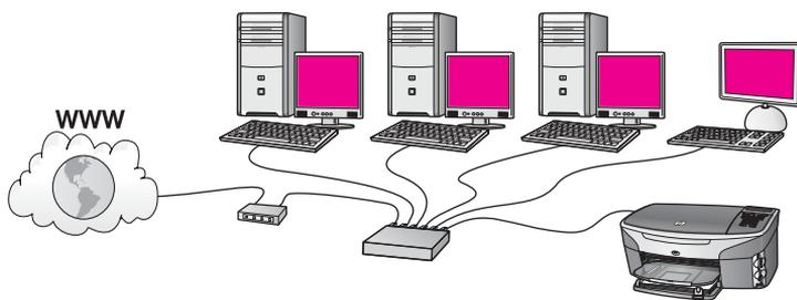
U ovom primjeru usmjerivač upravlja mrežnim mjestima, a DSL ili kabelski modem omogućavaju pristup Internetu. Ako koristite ovu konfiguraciju, spojite HP all-in-one na usmjerivač pomoću Ethernet kabela.
