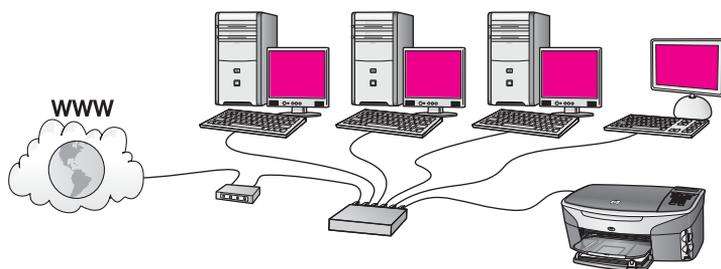
В този пример мрежовите връзки се управляват от рутер, а интернет достъпът се предоставя от DSL или кабелния модем. Ако използвате тази конфигурация, свържете HP all-in-one към рутера с помощта на Ethernet кабел.
