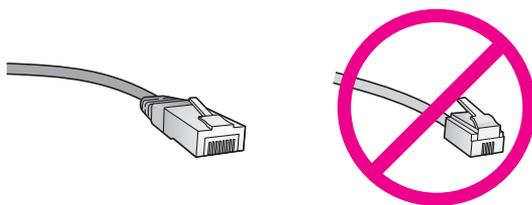
Въпреки приликата между стандартните Ethernet кабели и стандартните телефонни кабели, те не са взаимозаменяеми. Те са с различни съединители и различен брой проводници. Съединителят на Ethernet кабелите (също наречен RJ-45 съединител) е по-широк и по-плътен и е с 8 контакта. Телефонният съединител има между два и шест контакта.
