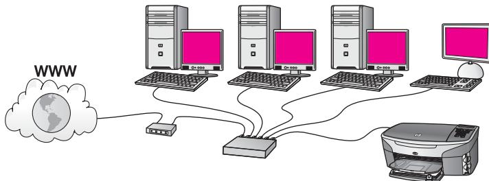
Šajā piemērā maršrutētājs pārvalda tīkla savienojumus, un DSL vai kabeļa modems nodrošina pieeju Internetam. Ja jūs izmantojat šo konfigurāciju, pievienojiet savu HP all-in-one maršrutētājam ar Ethernet kabeli.
