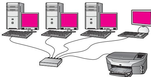
Šajā piemērā tīkla iekārtas tiek pieslēgtas komutatoram vai maršrutētājam, un Interneta pieslēguma nav. Iekārtas izmanto AutoIP, kas nozīmē to, ka IP adreses tiek konfigurētas automātiski. Ja jūs izmantojat šo konfigurāciju, pievienojiet HP all-in-one komutatoram vai maršrutētājam ar Ethernet kabeli. Pieslēgšanas instrukcijas skatiet nodaļā [Pieslēgšana ar Ethernet kabeli](#).
