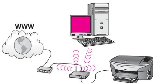
Jūsu pieejas punkts iekārtu ar vadiem pievieno bezvadu tīklam. Šajā modeļā jūsu dators tiek konfigurēts darbam bezvadu tīklā, izmantojot bezvadu tīkla adapteri, un tas pārraida un saņem datus caur pieejas punktu. HP all-in-one tiek konfigurēts darbam vadu tīklā un tiek pievienots pieejas punktam ar Ethernet kabeli. DSL vai kabeja modems var nodrošināt Interneta pieeju. Pieslēgšanas instrukcijas skatiet nodaļā [Pieslēgšana ar Ethernet kabeli](#).
