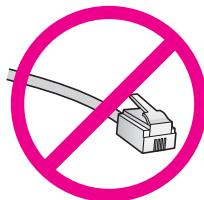
Kaut arī standarta Ethernet kabeli izskatās līdzīgi standarta telefona kabeljiem, tie nav savstarpēji aizvietojami. Tajos ir atšķirīgs vadu skaits, un tiem ir dažādi savienotāji. Ethernet kabeļa savienotājs (saukts arī RJ-45 savienotājs) ir platāks un biezāks, un tam galā vienmēr ir 8 kontakti. Telefona savienotājam ir no 2 līdz 6 kontaktiem.
