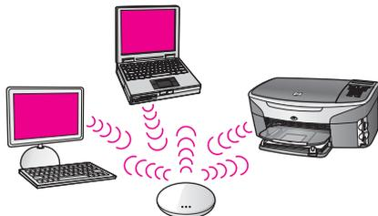
Sva bežična komunikacija između vaših mrežnih uređaja protiče preko točke pristupa (ili osnovne stanice). Točka pristupa funkcionira kao središnja utičnica ili gateway koji povezuje bežične uređaje. Svaki uređaj u bežičnoj mreži mora imati adapter koji ga povezuje na točku pristupa. Ta mrežna konfiguracija nema pristup Internetu. Za upute o vezi vidi [Povezivanje s bežičnom mrežom preko točke pristupa](#).
