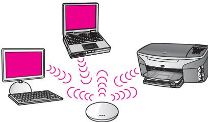
Semua komunikasi nirkabel antara perangkat-perangkat yang ada dalam jaringan dilakukan melalui access point (atau base station). Access point bertindak sebagai hub sentral atau gateway yang menghubungkan perangkat-perangkat nirkabel. Setiap perangkat jaringan nirkabel harus memiliki adapter yang menghubungkannya ke access point. Konfigurasi jaringan ini tidak memiliki akses Internet. Untuk instruksi-instruksi koneksi, baca [Hubungkan ke jaringan nirkabel dengan access point](#).
