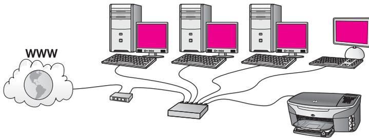
この例では、ルーターがネットワーク接続を管理し、DSL またはケーブル モデムがインターネットにアクセスします。この構成を使用する場合は HP all-in-one を Ethernet ケーブルでルーターに接続します。
