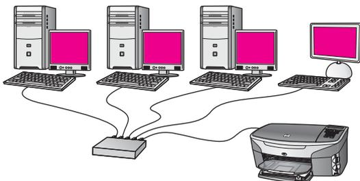
この例では、ネットワーク デバイスはスイッチまたはルーターには接続されていますが、インターネットへは接続されていません。デバイスは AutoIP を使用するため、IP アドレスは自動的に設定されます。この構成を使用する場合は、HP all-in-one を Ethernet ケーブルでスイッチまたはルーターに接続します。接続方法については、[Ethernet ケーブルで接続する](#) を参照してください。
