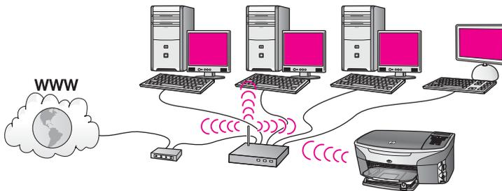
アクセスポイントを使用して、ワイヤレスネットワークを有線ネットワークへ接続することができます。このモデルでは、お使いのコンピュータを有線ネットワーク用に設定し、Ethernet ケーブルでアクセスポイントに接続します。インフラストラクチャモードに HP all-in-one を設定すると、ワイヤレスアダプタがアクセスポイントを介してデータの送受信をできるようになります。DSL またはケーブルモデムを使用して、インターネットへのアクセスが得られます。詳細については、アクセスポイントによるワイヤレスネットワークへの接続を参照してください。
