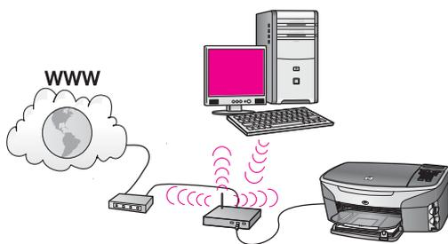
アクセス ポイントによって有線デバイスがワイヤレス ネットワークに接続されます。このモデルでは、ワイヤレス ネットワーク アダプタを使用してコンピュータをワイヤレス ネットワーク用に設定し、データの送受信はアクセス ポイント経由で行います。HP all-in-one は有線ネットワーク用に設定し、また Ethernet ケーブルでアクセス ポイントに接続します。DSL またはケーブル モデムがインターネットにアクセスします。接続方法については、[Ethernet ケーブルで接続する](#) を参照してください。
