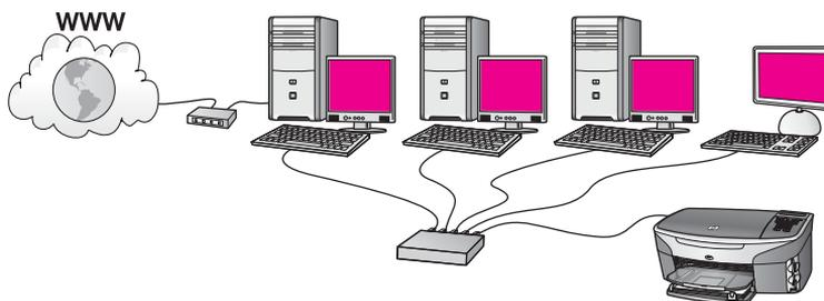
この例では、ネットワーク デバイスはスイッチまたはルーターに接続され、モデム（この図では左側のコンピュータに接続されている）がインターネットにアクセスします。モデムは、電話コードとジャックを使用してコンピュータに接続されています。1台のコンピュータだけがインターネットにアクセス
