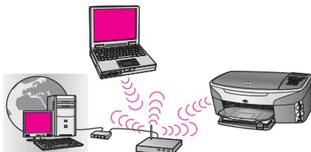
ワイヤレス ルーター (またはアクセス ポイント) は、ネットワーク接続を管理し、また DSL モデムまたはケーブル モデムを使用することでインターネットへのアクセスが得られます。お使いのネットワークがこのような構成になっている場合、インフラストラクチャ モードで HP all-in-one をルーターに接続する際には、ワイヤレス セットアップ ウィザードを使用してください。接続の手順についての詳細は、[アクセス ポイントによるワイヤレス ネットワークへの接続](#) を参照してください。
