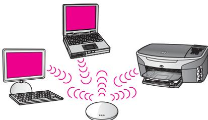
ネットワーク機器間の全てのワイヤレス通信はすべてアクセス ポイント (または無線基地局) を経て行われます。アクセス ポイントは、ワイヤレス機器を接続する中央ハブやゲートウェイの役割を果たします。それぞれのワイヤレス ネットワーク機器には、アクセス ポイントへの接続を行うアダプタが組み込まれていなければなりません。このネットワーク構成ではインターネット
