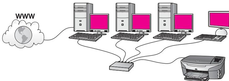
この例では、ネットワーク機器はスイッチまたはルーターに接続されます。ネットワーク上の1台のコンピュータが、ネットワークとインターネット間のゲートウェイとなります。このゲートウェイコンピュータは、Windows Internet Connection Sharing (ICS) が類似のソフトウェアを使ってネットワーク接続を管理し、また他の機器がインターネットにアクセスできるようにします。
