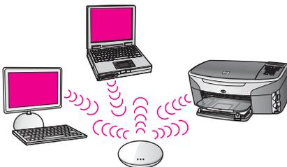
Toda a comunicação sem fio entre os dispositivos de rede é feita através de um ponto de acesso (ou estação base). O ponto de acesso atua como um hub central ou gateway que conecta os dispositivos sem fio. Cada dispositivo sem fio deve ter um adaptador que o conecta ao ponto de acesso. Esta configuração de rede não possui acesso à Internet. Para instruções sobre conexão, consulte [Como conectar uma rede sem fio a um ponto de acesso](#).
