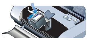
5 Schließen Sie die Verriegelung der Patrone. Wenn die Patrone richtig eingesetzt wurde, wird sie beim Schließen der Verriegelung sanft in die Halterung geschoben. Drücken Sie auf die Verriegelung, um sicher zu stellen, dass sie flach auf den Patronen aufliegt.
