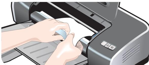
清除卡纸后，关闭所有机盖，打开打印机电源（若已关闭），然后按“继续”按钮。打印机将从下一页继续打印作业。需要重新发送出现卡纸的那几页文件。
