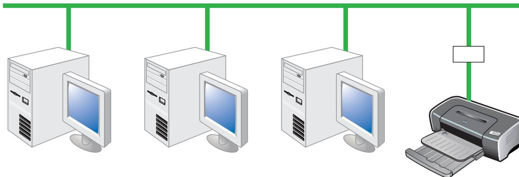
可以通过可选的 HP Jetdirect 外置打印服务器将打印机直接连接网络，从而在网络环境共享打印机。此配置提供的性能比通过计算机打印好，还提供了打印机放置位置的灵活性，而且让 Windows 和 Mac OS 用户都能共享打印机。
