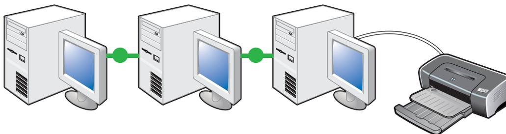
在本地共享网络上，打印机直接连接所选计算机（称为“服务器”）的 USB 或并行端口，并与其他计算机（客户机）共享。仅在小型工作组或使用量较低时使用此配置。当许多用户使用共享打印机打印时，会降低服务器的速度。
