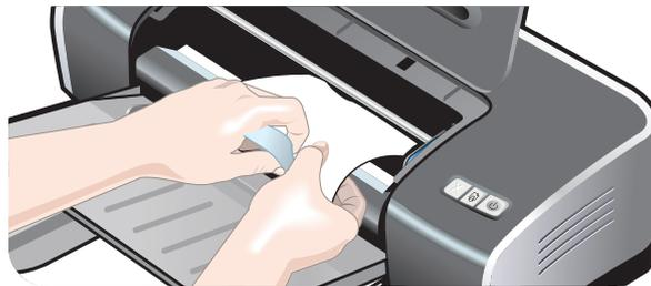
Schließen Sie nach dem Beheben des Papierstaus alle Abdeckungen, schalten Sie den Drucker ein (falls er ausgeschaltet wurde) und drücken Sie die Fortfahren-Taste. Der Drucker setzt den Druckauftrag auf der nächsten Seite fort. Sie müssen die im Drucker gestauten Seiten erneut an den Drucker senden.
