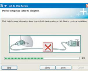
**Problem:** (Samo Windows) Pojavio se zaslon **Device Setup Has Failed To Complete** (Postavljanje uređaja nije uspjelo).
