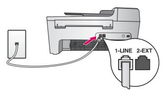
将随附电话线的一端连接至左侧的电话端口 (1-LINE) 内, 并将另一端连接至墙壁上的插孔内。
