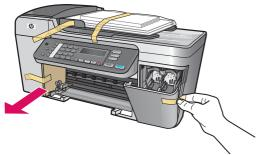
请确保取下设备内部所有的胶带和纸板。
