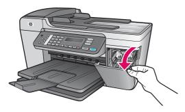
放下检修门。同时将打印支架移向右侧。如果支架卡住,请参阅最后一 页的"**疑难排解"**。
