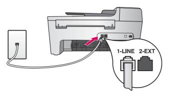
將提供的電話線一頭連接到左側 (1-LINE) 的電話埠,另一頭連接到牆上的插座。
