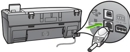
3. Conecte a outra extremidade do cabo Ethernet a uma porta disponível no roteador Ethernet, no switch ou no roteador sem fio.
