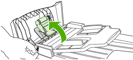
5. Soulevez l'ensemble de bras de charge, faites-le glisser vers l'avant du multifonction pour sortir le côté comportant l'engrenage de l'ensemble, puis dégagez l'ensemble du multifonction.
