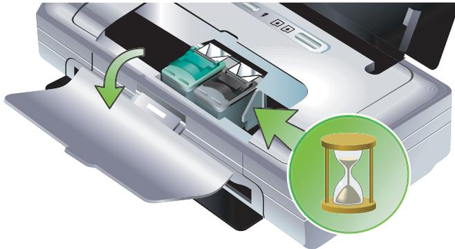
3. Heben Sie die Patronenverriegelung an, und entfernen Sie die Druckpatrone vorsichtig aus der Halterung.
