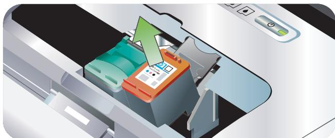
2. Reinigen Sie die elektrischen Kontakte an der Halterung der Patronenhalterung mit einem trockenen Wattestäbchen.
