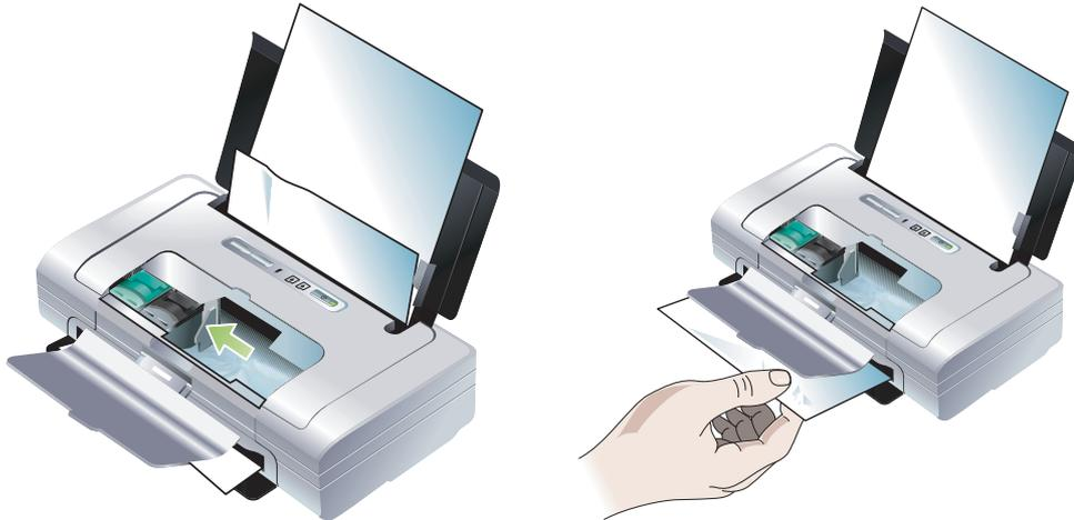
7. Falls die gestauten Medien im Druckbereich innerhalb des Druckers nicht sichtbar sind, entfernen Sie die sichtbaren Medien aus dem Eingabefach.
