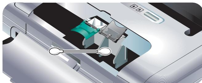
3. Reinigen Sie die elektrischen Kontakte an der Patrone vorsichtig mit einem weichen, trockenen, flusenfreien Lappen.
