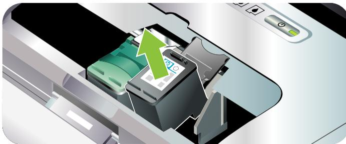
4. Setzen Sie die neue Patrone im selben Winkel in die Halterung ein, unter dem Sie die alte Patrone entfernt haben. Vergleichen Sie die Nummer auf der Verriegelung mit der Nummer auf der Druckpatrone, um sicher zu gehen, dass Sie die richtige Patrone einsetzen.
