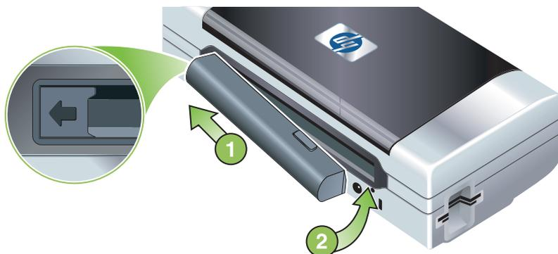
1. Schieben Sie die Batterie schräg ins Batteriefach, bis die Batteriekontakte an den Kontakten im Batteriefach anliegen. Die Abdeckung der Batteriekontakte wird geöffnet.
