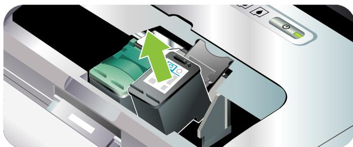
4. 用和取出舊列印墨水匣時一樣的角度，將新的列印墨水匣裝入其安裝底槽。檢查固定鎖和列印墨水匣上面的號碼是否相符，確定您裝入正確的字印墨水匣。
