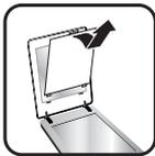
3. 将正片面朝下放在相应模板中，使图像顶部朝上。
