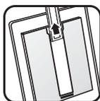
4. 将底片条滑入底片条夹，使底片的光面朝向您。
