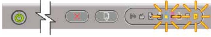
إضاءة ضوء الطاقة Power ووميض ضوء خرطوشة الحبر Ink Cartridge بالإضافة إلى ضوء أو أكثر من أضواء الألوان.
