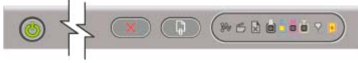
إضاءة ضوء الطاقة Power وضوء خرطوشة الحبر Ink Cartridge وضوء أو أكثر من أضواء الألوان.
