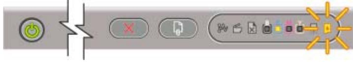
إضاءة ضوء الطاقة Power وضوء أو أكثر من أضواء الألوان، ووميض ضوء خرطوشة الحبر Ink Cartridge.
