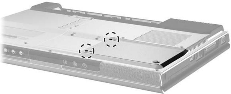
3. 若要移除硬碟蓋並露出硬碟卡榫 ①，請輕輕將外蓋 ② 向左推，再向上將外蓋抬起，從筆記型電腦上取下。
