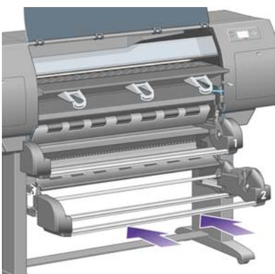
**25.** Baje la palanca de sujeción.
