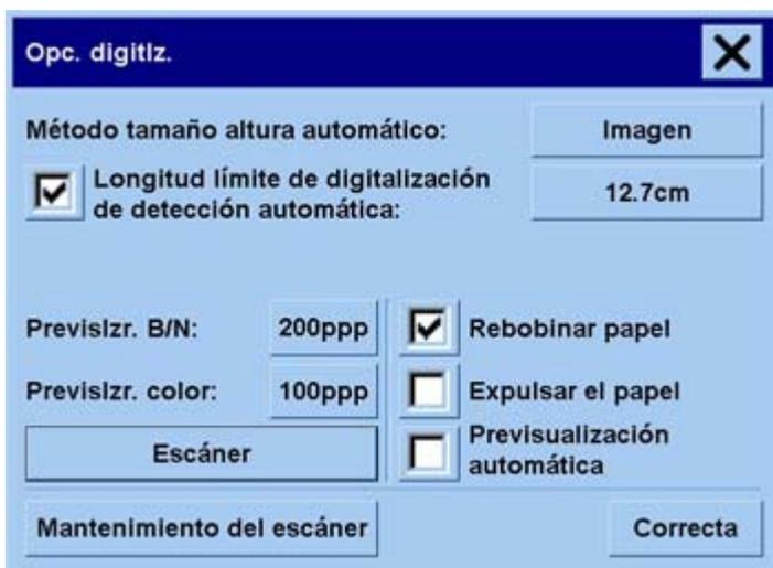
5. Pulse el botón **Mantenimiento del escáner** en la casilla Opciones de escaneo.
