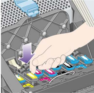
Al insertar el nuevo cabezal de impresión, puede que éste presente cierta resistencia, por lo que deberá presionarlo hacia abajo de un modo firme aunque suave.
