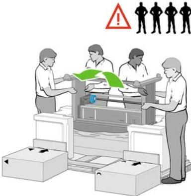
3. Gire la impresora hasta que la parte posterior descanse sobre las cajas de repuesto y consumibles y las ruedas con el material antideslizante toquen el suelo.
