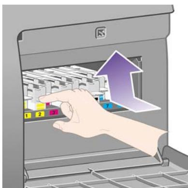
4. Levante el limpiador de cabezal de impresión para extraerlo de la ranura y deslícelo hacia afuera en dirección horizontal, como se muestra a continuación.
