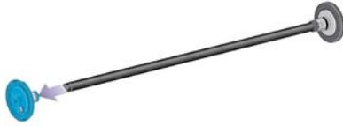
2. Si el diámetro del cilindro interior del rollo es de 7,62 cm (3 pulgadas), compruebe que se han instalado los adaptadores de cilindros suministrados con la impresora. Vea la siguiente figura:
