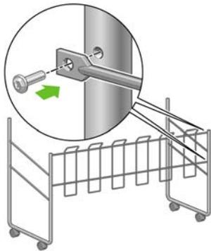
5. Ajuste la segunda estructura transversal al conjunto de bandeja mediante los cuatro tornillos.
