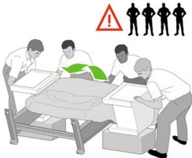
6. Gire la impresora hasta colocarla en posición vertical. El material antideslizante debe impedir que la impresora se deslice hacia delante.
