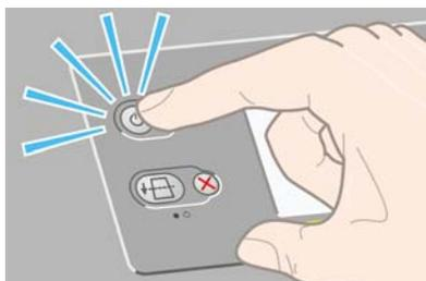
4. Espere hasta que aparezca el siguiente mensaje en el panel frontal. Resalte el idioma que desee con ayuda de las teclas de flecha hacia arriba y hacia abajo. Pulse la tecla Seleccionar.
