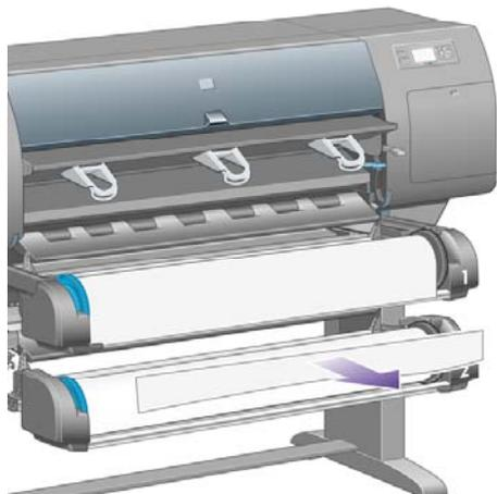
6. 向后转动卷轴，将纸张边缘移到一侧。
