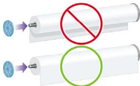
确保卷筒和卷轴右端的固定挡塞之间没有空隙。
