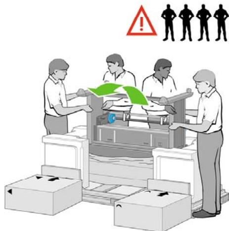
3. 继续旋转打印机，直至其后部靠在备件箱和耗材箱上，并且带防滑材料的脚轮触及地板。
