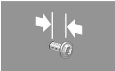
4. 将一个螺丝固定到支架右侧支腿的内侧。
