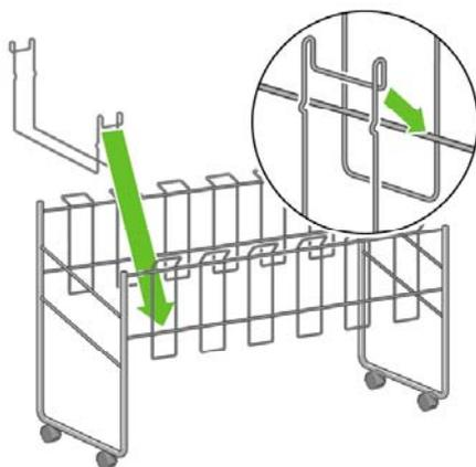
7. 将接纸圈的另一端连接到交叉框架。
