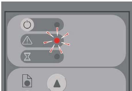
最可能的原因是扫描区需要清洁。请按联机指南中所述，执行日常维护步骤，该步骤包括清洁。完成维护步骤后，请重新启动扫描仪。
