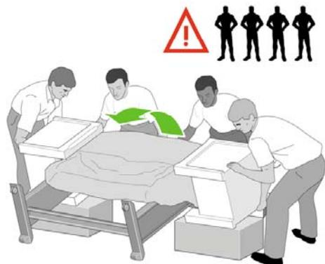
6. 将打印机转至竖直位置。防滑材料应阻止打印机向前滑动。
