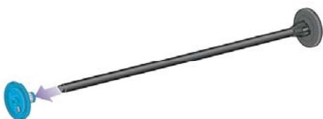
2. 如果使用三英寸的硬纸管，则检查是否已安装随打印机提供的卷纸管适配器。参见以下内容：
