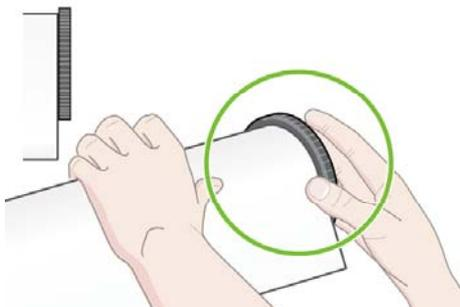
7. 将蓝色纸张挡塞放回卷轴另一端，然后朝卷筒一端推动。
