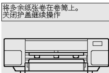
12. 将多余纸张卷到卷筒上。按下图所示的方向，使用纸张挡塞转动卷筒。
