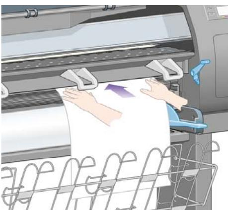
7. 如下图所示，继续将单张纸张插入打印机，直至其重新出现。
