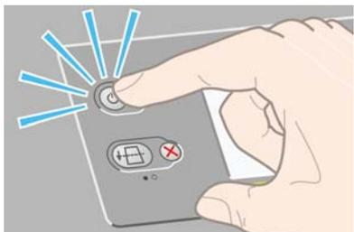
使用此方法关闭打印机电源时，打印机会自动存储打印头和打印头清洁器，从而防止它们晾干。
