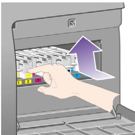
4. 如下图所示，向上提起打印头清洁器以将其从插槽中取出，然后将其水平滑出。
