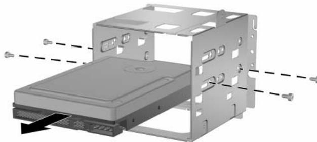
*Remoção de uma Unidade de Disco Rígido de 3,5 polegadas*
