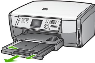
3. Legen Sie den Stapel Karten mit der schmalen Kante nach vorne und der **zu bedruckenden Seite nach unten** ganz rechts in das Hauptfach ein. Schieben Sie den Stapel bis zum Anschlag nach vorne.
