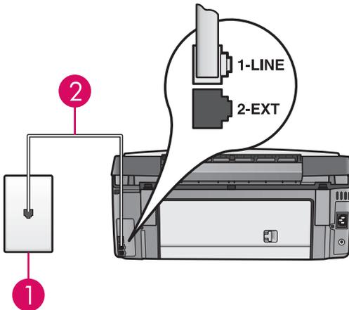
Schließen Sie das eine Ende des Telefonkabels an den Telefonanschluss auf der linken Seite (**1-LINE**) und das andere Ende an einer Wandsteckdose an.
