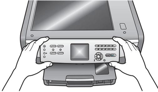
b Richten Sie die Abdeckblende an den Tasten am Gerät aus.
