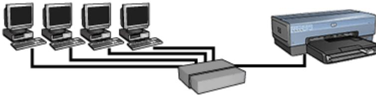
En este ejemplo, los dispositivos de red están conectados a un **concentrador** y utilizan **IP automática** para obtener las direcciones IP.
