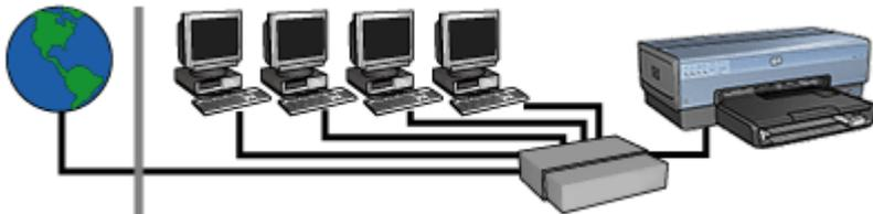
此示例看起来与第一示例相似。然而，在此示例中，网络设备是连接到**集线器**，而不是**路由器**。集线器可直接连接到互联网。
