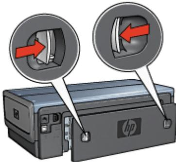
4. 从打印机的后方，将打印机内部的所有纸张拉出。
