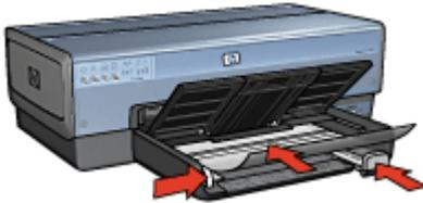
5. 将投影胶片小心推入打印机直到停住为止，注意不要让粘合带粘在一起。
