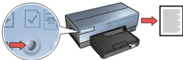
如果打印机刚连接到网络，请等待几分钟后才打印“HP 报告”页，以便让打印机可以有时间获取有效的设置。
