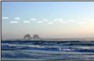
如果距照片某一长边大约 63 毫米（2.5 英寸）的浅色部分中出现条纹，请尝试以下的解决方法：
