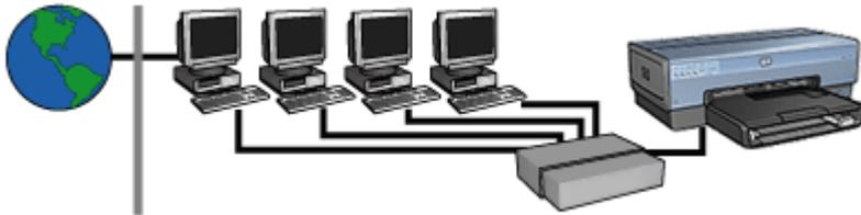
在此示例中，网络设备将连接到**集线器**。网络中的一台计算机被用作网络和互联网之间的**网关**。网关计算机使用 **Windows 互联网连接共享 (ICS)** 管理网络连接以及为其他设备提供互联网访问。
