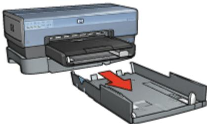
2. 滑动纸张宽度导轨，直到箭头和正确设置对齐。
