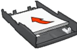
4. 将下层纸盘插入底座直到使它卡入定位。
