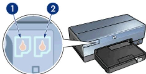
1. 左侧状态指示灯代表安装于打印墨盒底座左侧的三色打印墨盒。
