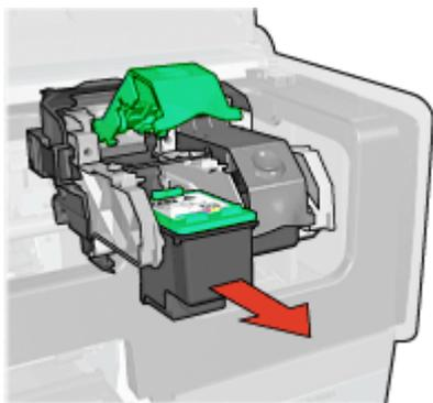
6. 将替换打印墨盒从包装中取出，小心撕下胶带。握住打印墨盒，使铜带位于下方且朝向打印机。
