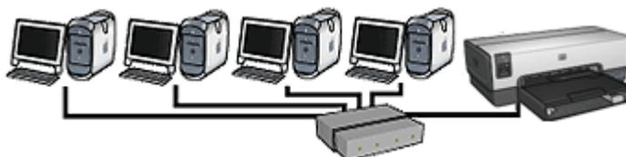
En este ejemplo, los dispositivos de red están conectados a un **concentrador** y utilizan **IP automática** para obtener las direcciones IP.
