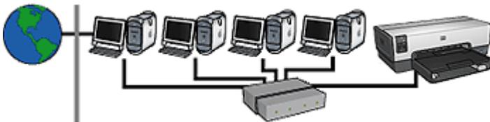
在此示例中，网络设备将连接到**集线器**。网络上的一台 Macintosh OSX 计算机作为网络和 Internet 之间的**网关**。网关计算机使用**互联网共享**管理网络连接以及为其他装置提供互联网访问。
