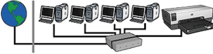
此示例看起来与第一示例相似。然而，在此示例中，网络设备是连接到**集线器**，而不是**路由器**。集线器可直接连接到互联网。
