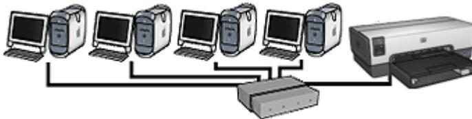
在此示例中，网络设备将连接到**集线器**。设备使用 **AutoIP** 来取得 IP 地址。
