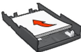
4. Schieben Sie das untere Fach in die Basiseinheit hinein, bis es einrastet.
