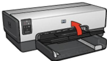
Pour éviter que le papier ne tombe du bac de sortie, déployez entièrement l'extension. Lorsque vous imprimez en mode Brouillon rapide, sortez la butée de l'extension du bac de sortie.
