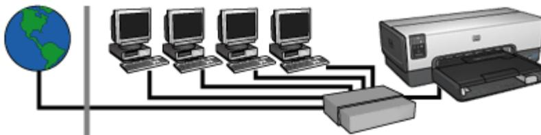
Dans cet exemple, un **routeur** gère les connexions réseau et sert de **passerelle** entre le réseau et Internet.
