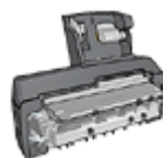
具备小型纸盘的自动双面打印附件
