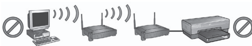
1 L'ordinateur et l'imprimante se trouvent sur des sous-réseaux différents.
