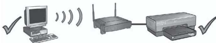
2 L'ordinateur et l'imprimante se trouvent sur le même sous-réseau.
