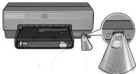
5. Espere a que las luces de la impresora parpadeen simultáneamente tres veces.
