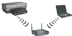
Utilice este tipo de conexión si desea establecer una conexión inalámbrica (802.11b o g) entre la impresora y la red.
