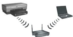
Use este tipo de conexão se desejar uma conexão sem fio (802.11b ou g) entre a impressora e a rede.
