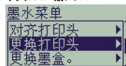
3 等待前面板显示“打开护盖以更换打印头”。然后，打开护盖并找到笔架组件。
