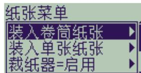
3 选择**装入卷筒纸张**并按**输入键**。以下信息将会显示，并带有纸张类型列表：默认选择为上次使用的纸张类型。
