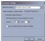
5. Ubah nilai untuk masing-masing kamera scanner. Umumnya, hanya nilai positif yang digunakan.
