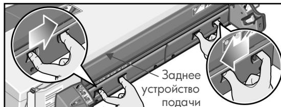
Снятие заднего устройства подачи открывает доступ сзади внутрь принтера.
