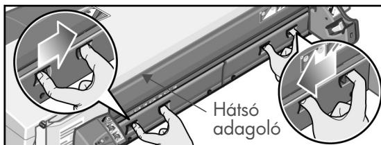
A hátsó adagoló eltávolítása után hátulról is hozzáfér a nyomtató belsejéhez.
