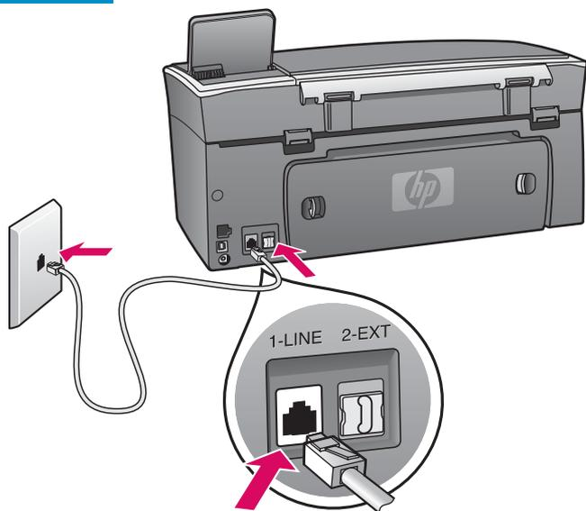
付属の電話コードの一方のコネクタを左側の電話ポート **1-LINE (回線 1)** に接続し、もう一方のコネクタを壁側ジャックに接続します。
