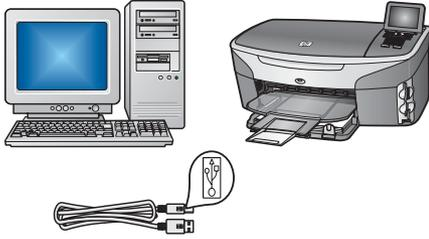
プリンタを 1 台のコンピュータに直接接続する場合は、この接続タイプを使用します。ソフトウェアの指示があるまで、接続しないでください。
