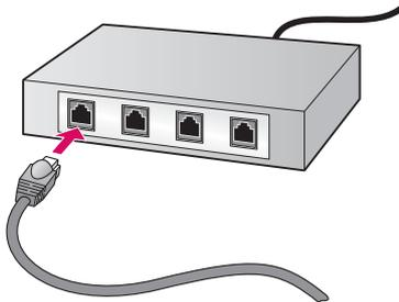
**重要:** Ethernet ケーブルはファクス用のポートには接続しないでください。ネットワークは動作中である必要があります。既に USB ケーブルを接続している場合は、USB ケーブルは外してください。
