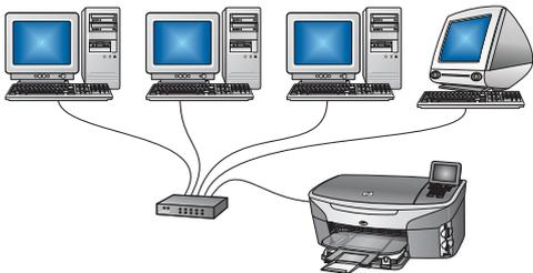
プリンタとネットワーク間を Ethernet ケーブルで接続する場合は、この接続タイプを使用します。
