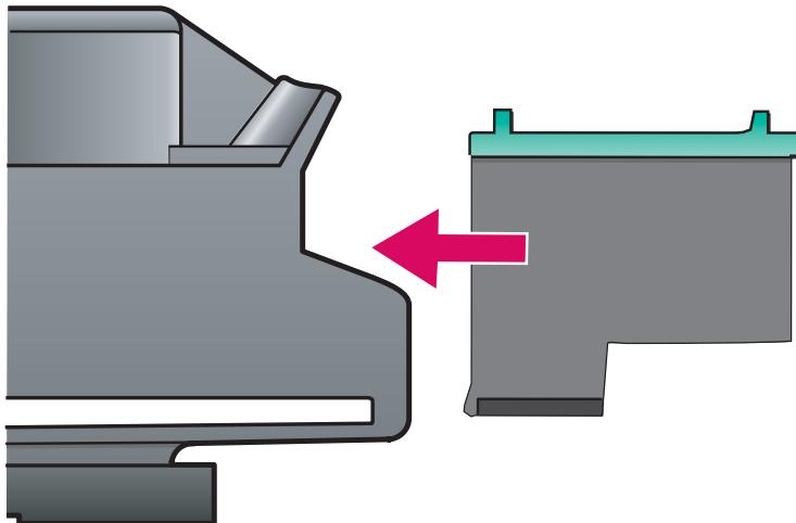
De printcartridges kunnen alleen worden geplaatst als het apparaat is **ingeschakeld**. Zorg ervoor dat de wagen met printcartridges aan de rechterkant staat.
