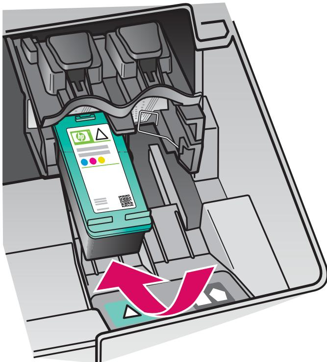
Le périphérique doit être **activé** avant de pouvoir insérer les cartouches d'impression. Assurez-vous que le chariot d'impression est positionné sur la droite.
