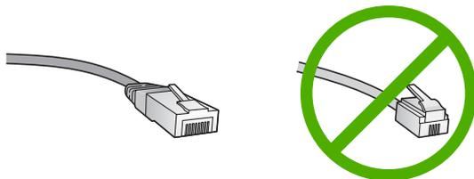
標準の Ethernet ケーブルは普通の電話ケーブルと似ていますが、互換性はありません。この2種類のケーブルでは線の本数が異なり、また異なるコネクタが付いています。Ethernet ケーブルコネクタ (すなわち RJ-45 コネクタ) は幅が広く厚みがあり、末端の接触部分は常に8箇所あります。電話ケーブルのコネクタは接触部分が2箇所から6箇所の間です。
