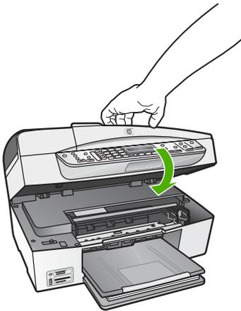
9. 新しいプリントカートリッジを取り付けた場合、プリントカートリッジ調整プロセスが始まります。
