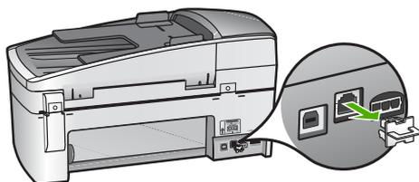
2. HP All-in-One 背面の Ethernet ポートに Ethernet ケーブルを接続します。
