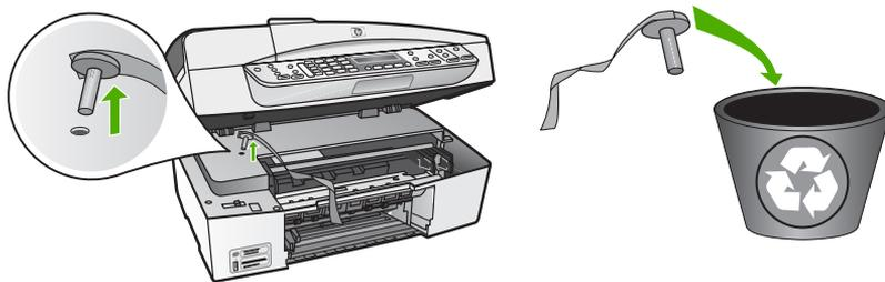
オレンジ色の出荷用止め具を取り除いた後、HP All-in-One の電源を入れ直します。
