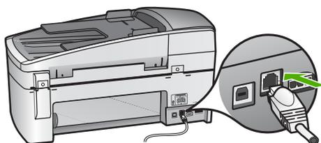
3. Ethernet ケーブルのもう一方の端を Ethernet ルーター、スイッチまたはワイヤレス ルーターの空いているポートに接続します。
