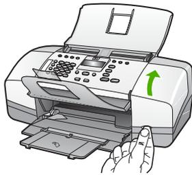
3. 待列印滑動架停止不動而且不再發出聲音，再輕輕壓下列印墨匣將它鬆開。
