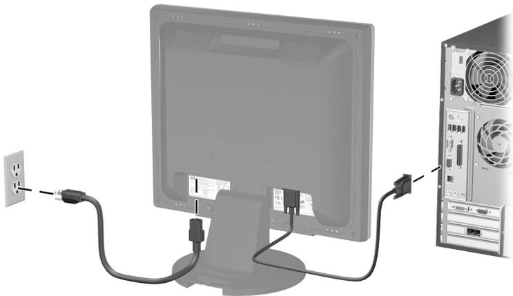
*Conexión de Cables de Alimentación y de Señal*
