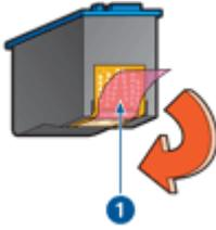
1 | Rimozione del nastro di plastica
