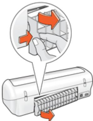
5. Извлеките замятую бумагу из задней части принтера и установите на место заднюю дверцу.
