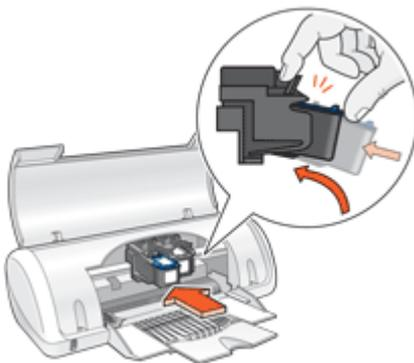
7. Empuje el cartucho en el receptáculo. Cuando el cartucho de tinta esté correctamente colocado, oirá un chasquido.
