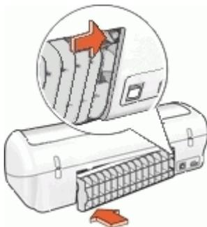
6. Si no puede retirar el papel atascado desde la parte posterior de la impresora, suba la cubierta, retire el papel por la parte delantera de la impresora y vuelva a bajar la cubierta.
