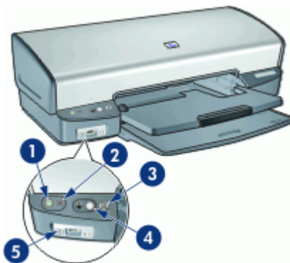
1 Strömknapp och strömlampa 2 Knapp för att avbryta utskrift 3 Knapp och lampa för fortsatt utskrift 4 Photosmart Express-knapp 5 USB-port på framsidan
