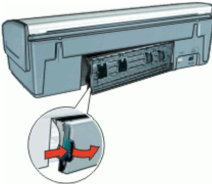
4. Entfernen Sie das im Drucker befindliche Papier, indem Sie es von der Rückseite des Druckers aus herausziehen.
