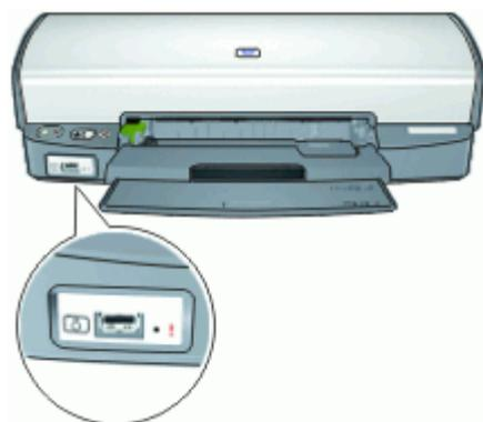
Um Fotos über den vorderen USB-Anschluss zu drucken, benötigen Sie ein USB-Kabel, das mit der Kamera kompatibel ist. HP empfiehlt ein Kabel, das weniger als 3 m lang ist.
