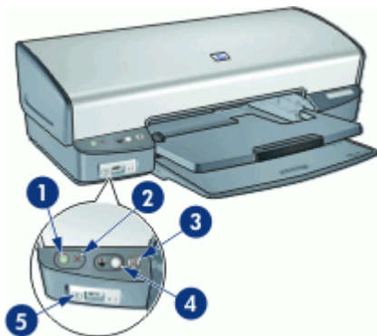
1 Botón y luz de encendido 2 Botón Cancelar impresión 3 Botón e indicador luminoso Reanudar 4 Botón Photosmart Express 5 Luces del puerto USB delantero
