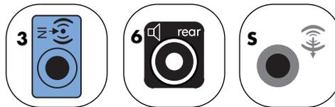
Pour le type à trois connecteurs, le connecteur d'entrée audio bleu fonctionne comme une sortie audio arrière lorsqu'une configuration multivoie est activée.
