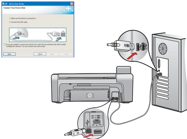
**SL** **Windows:** Ko se pojavi poziv za USB, priključite kabel USB v vrata na hrbtni strani naprave HP All-in-One in nato v katera koli vrata USB na računalniku.
