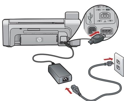
**SL** Priključite napajalni kabel in napajalnik.
