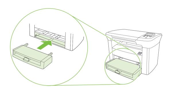
3 Install the output bin. ● 安装出纸槽。
